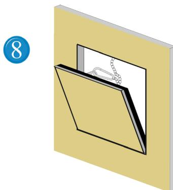
8 Hängen Sie aus Sicherheitsgründen die Fangsicherung ein und schließen Sie die Revisionsklappe. Bitte beachten Sie dies auch nach jedem Öffnen der Klappe.
