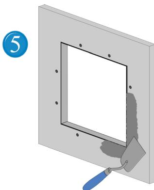
5 Spachteln Sie jetzt bei beiden Rahmen den umlaufenden Anschluss an die Gipskartonbeplankung inkl. der Schrauben.
