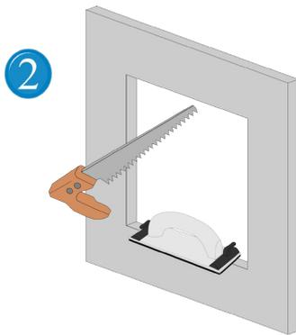
2 Schneiden Sie den Einbau-Ausschnitt nun aus. (Stichsäge, Fuchsschwanz...) Bitte achten Sie darauf, dass die Kanten gerade und frei von Rückständen sind.
