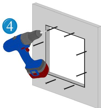
4 Drücken Sie den Rahmen von hinten an die Wand-/Deckenplatte. Nun verschrauben Sie den äußeren Einbaurahmen mit Bohrkopfschrauben im Abstand von max. 17 cm an der Gipskartonwand /-decke.
