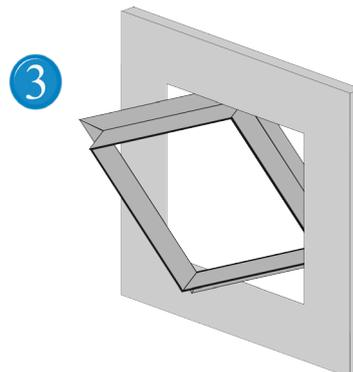
3 Nehmen Sie das Türblatt aus dem Außenrahmen und führen Sie diesen durch die Öffnung in den Wand-/Deckenhohlraum. Bitte beachten Sie bei Wandeinbau die Öffnungsrichtung: Die Schnappverschlüsse müssen sich oben befinden.
