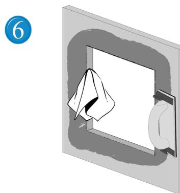
6 Putzen Sie bitte die beiden Alu-Rahmen der Revisionsklappe sauber ab. Dies ist besonders wichtig, damit die Funktion der Revisionsklappe nicht beeinträchtigt wird. Schleifen Sie nach dem Trocknen Unebenheiten ab.
