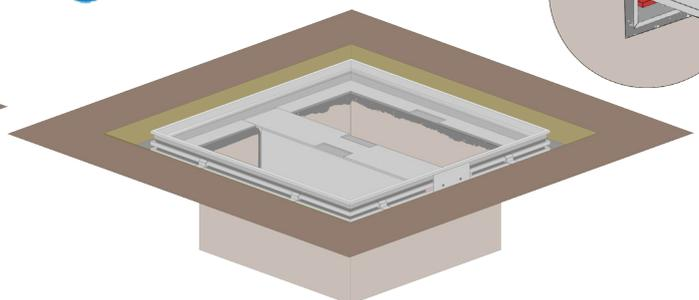
Legen Sie ggf. die Stützbalken in die Halterungen und richten Sie sie so aus, dass ihre Oberseite eben mit der Unterseite des Rahmens ist. Legen Sie dazu die Ausgleichsplättchen in die Halterungen und füllen Sie den Spalt zwischen dem Boden der Halterung und dem Plättchen mit Epoxid-Mörtel.
