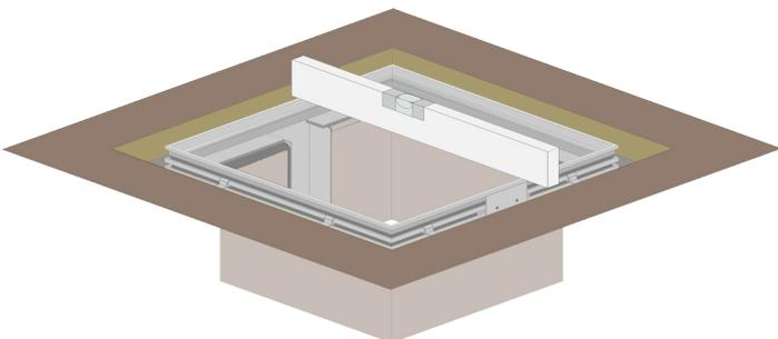
Tragen Sie in der Aussparung am Boden Mörtel auf und setzen Sie den Außenrahmen über der Durchgangsöffnung auf den Mörtel. Richten Sie den Rahmen flächenbündig auf die Höhe des Endbodenbelags aus.
