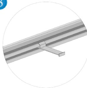
Befestigen Sie bei Aluminiumklappen die Ankerbolzen an den Außenkanten des Außenrahmens im Abstand von ca. 600 mm indem Sie diese mit einer Zange falzen. Biegen Sie bei Edelstahlklappen die bereits montierten Befestigungsanker am Außenrahmen um 90° nach oben und falzen Sie sie um 90° nach außen.
