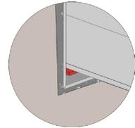
Achten Sie ggf. darauf, dass die Halterungen der Stützbalken komplett mit Mörtel umschlossen sind.
