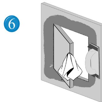
6 Putzen Sie bitte die beiden Alu-Rahmen der Revisionsklappe sauber ab. Dies ist besonders wichtig, damit die Funktion der Revisionsklappe nicht beeinträchtigt wird. Schleifen Sie nach dem Trocknen Unebenheiten ab.
