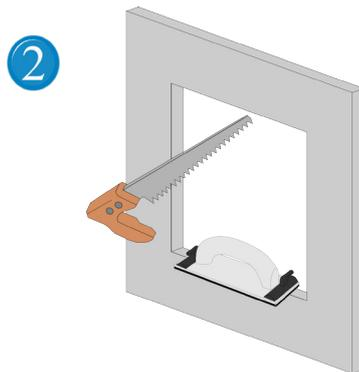
2 Schneiden Sie den Einbau-Ausschnitt nun aus. (Stichsäge, Fuchsschwanz...) Bitte achten Sie darauf, dass die Kanten gerade und frei von Rückständen sind.
