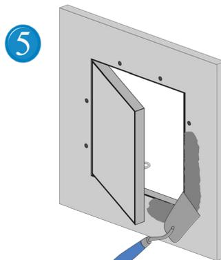
5 Spachteln Sie jetzt bei beiden Rahmen den umlaufenden Anschluss an die Gipskartonbeplankung inkl. der Schrauben.
