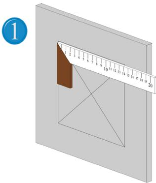
1 Bitte zeichnen Sie mithilfe eines rechten Winkels den Einbau-Ausschnitt an der Gipskartonwand/-decke an. (Bestellmaß + 5 mm)
