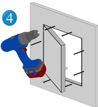
4 Drücken Sie den Rahmen von hinten an die Wand-/Deckenplatte. Nun verschrauben Sie den äußeren Einbaurahmen mit Bohrkopfschrauben im Abstand von max. 17 cm an der Gipskartonwand/-decke.
