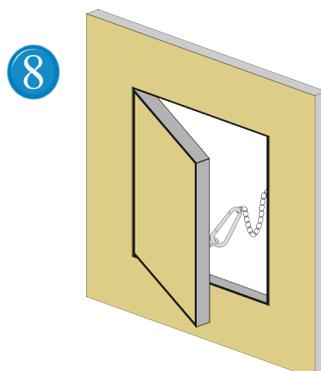
8 Hängen Sie aus Sicherheitsgründen die Fangsicherung ein und schließen Sie die Revisionsklappe. Bitte beachten Sie dies auch nach jedem Öffnen der Klappe.
