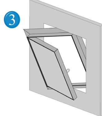
3 Führen Sie die Revisionsklappe durch die Öffnung in den Wand-/Deckenhohlraum. Bitte beachten Sie bei Wandeinbau die Öffnungsrichtung: Die Schnappverschlüsse müssen sich seitlich befinden.
