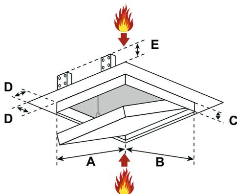
Beispiel EI60 mit 30 mm Fireboard C = 30 mm | D = 25 mm | E = 40 mm
