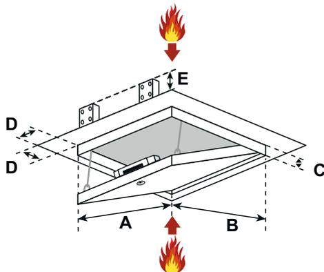
Beispiel EI30 mit 25 mm GKF | D = 28 mm | E = 40 mm
