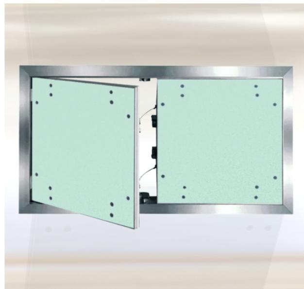
Die Revisionsklappe besteht aus Aluminiumprofilen, ohne oder mit Gipskartoneinlage 12,5 mm, 15 mm oder 25 mm und Schnappverschlüssen. Die Rahmen der Revisionsklappe bestehen aus je vier einzelnen Rahmenteilen, die durch ein spezielles Schweißverfahren fest miteinander verbunden sind.
