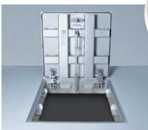
Schraub-Vorreiberverschluss inkl. einer Messing-Schutzkappe. Das Öffnen wird durch die hochwertigen Gasdruckfedern so unterstützt, dass die Schachtabdeckung von nur einer Person geöffnet und geschlossen werden kann. Eine Fallschutzvorrichtung verhindert das unkontrollierte Schließen. Die Aufbauhöhe beträgt 220 mm.
