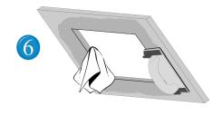
Drücken Sie den Rahmen von oben an die Deckenplatte.
