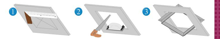
Bitte zeichnen Sie mithilfe eines rechten Winkels den Einbau-Ausschnitt an der Gipskartondecke an. (Bestellmaß + 5 mm) Schneiden Sie den Einbau-Ausschnitt nun aus inkl. der Isolierung aus Mineralwolle. (Stichsäge, Fuchsschwanz...) Bitte achten Sie darauf, dass die Kanten gerade und frei von Rückständen sind. Nehmen Sie das Türblatt aus dem Außenrahmen und führen Sie diesen durch die Öffnung in den Deckenraum, sodass sich der Rahmen zwischen der Gipsplatte und der Mineralwolle befindet.
