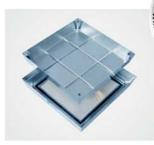
geruchs- und wasserdicht ist. Die Zarge wird bodengleich einbetoniert. Anschließend kann die Wanne befüllt werden und in die Zarge eingelegt werden. Die Befestigung des Deckels an der Zarge erfolgt an den 4 Eckpunkten. Der Deckel kann an diesen Punkten mit dem Hebeschlüssel auch heraus genommen werden. Eine Befüllung mit Fliesen, Beton, Kunstharz, Granit, Terrazzoplatten, Holz und Hartbodenbelägen oder anderen Materialien ist möglich.
